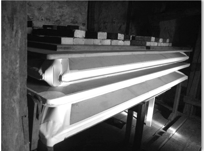
Nach 1895 die erste neue Beledung: Der Blasebalg im Turm
